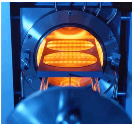
Fig. 1: Reaktor zur chemischen Gasphasenabscheidung metallischer Elektroden; Reactor used for the chemical vapor deposition of metal electrodes.
