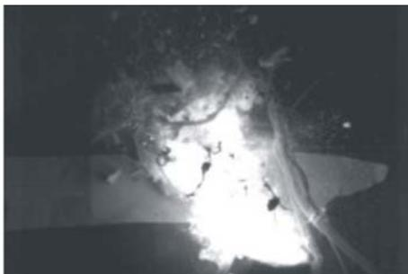
Fig. 2: Fortgeschrittene Explosion eines 1700 V, 400 A Einzel-IGBTs ohne Havarieschutzmaßnahme; Mid-stage of the explosion of a single IGBT 1700 V, 400 A without hazard protection.
