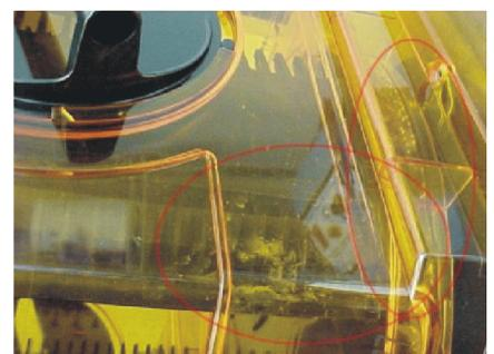
Fig. 1: Beispiele für weiße Kontaminationsrückstände auf Gummidichtungen der Türen, auf O-Ringen der Filterhalterungen und auf Rückseiten von separaten Scheibhalterungen (von links nach rechts) nach der FOUP-Reinigung. Mangelhafte Reinigungsergebnisse, wie hier abgebildet, waren in der Regel für jeden FOUP-Reiniger sichtbar;
