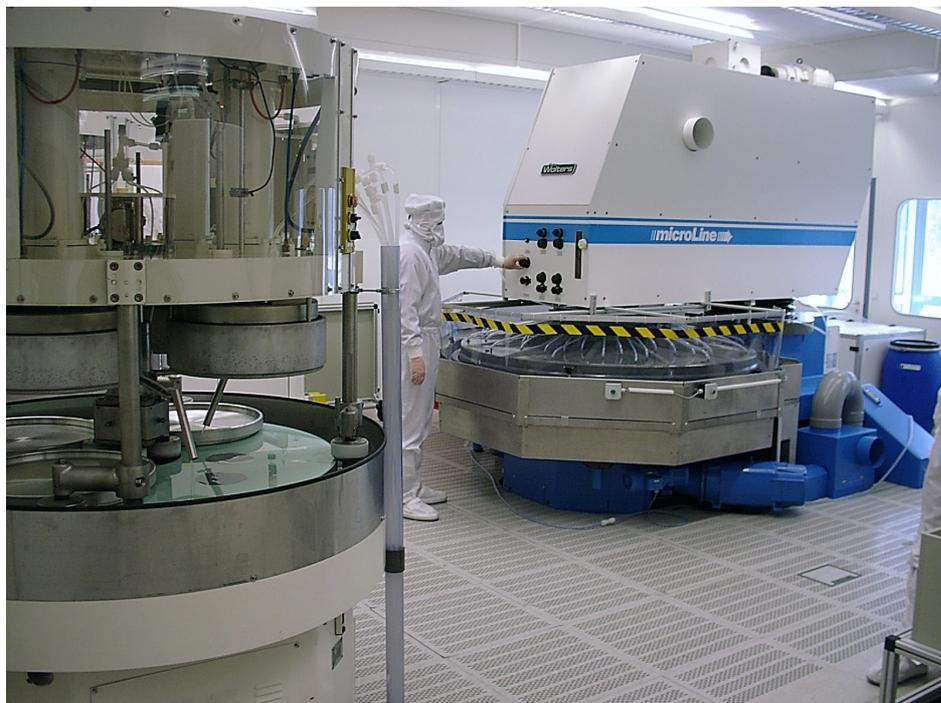
Fig. 1: Doppelseiten-Poliermaschine im Reinraum des IIS-B; Double-side polishing tool in the cleanroom of IIS-B.
