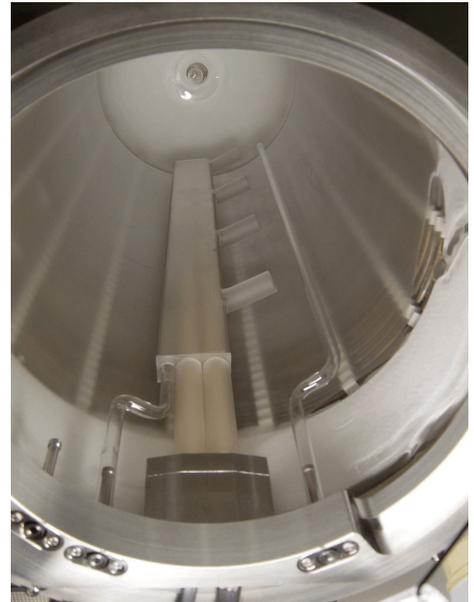
Fig. 1: Reaktorraum der ALD-Mehrscheibenprozeßanlage mit integrierter Plasmaquelle; View of the ALD batch reactor with the integrated plasma source.
