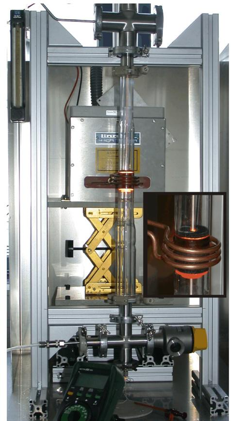
Fig. 2: Modellaufbau zur Bestimmung des Reaktionsverhaltens zwischen Silicium und Graphitwerkstoffen;
