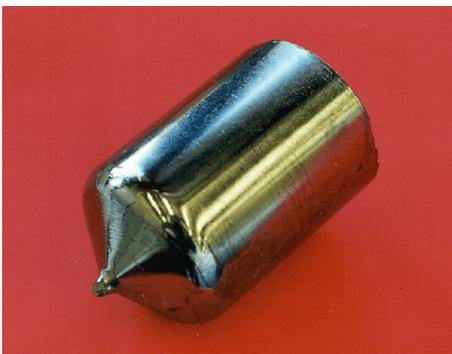
Defektarmer Galliumarsenid-Einkristall, der am Erlanger Kristall-Labor mit einer verbesserten VGF-Technologie hergestellt wurde; Low dislocation density gallium arsenide single crystal grown at the Crystal Growth Laboratory in Erlangen by improved VGF technology.
