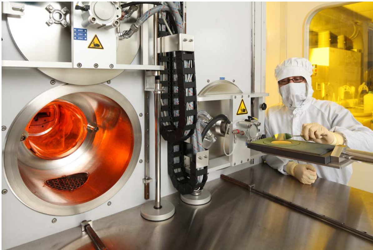
FuE-Reaktor am Fraunhofer IISB zur Herstellung von SiC-Epitaxieschichten. Foto: Fraunhofer IISB / Kurt Fuchs
