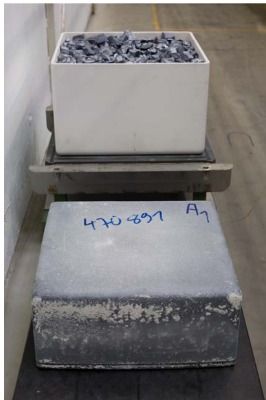
Kokille mit Siliziumausgangsmaterial vor der Kristallisation (Hintergrund), gezüchteter Siliziumblock nach der Kristallisation (Vordergrund) (Foto : Solarworld AG).
