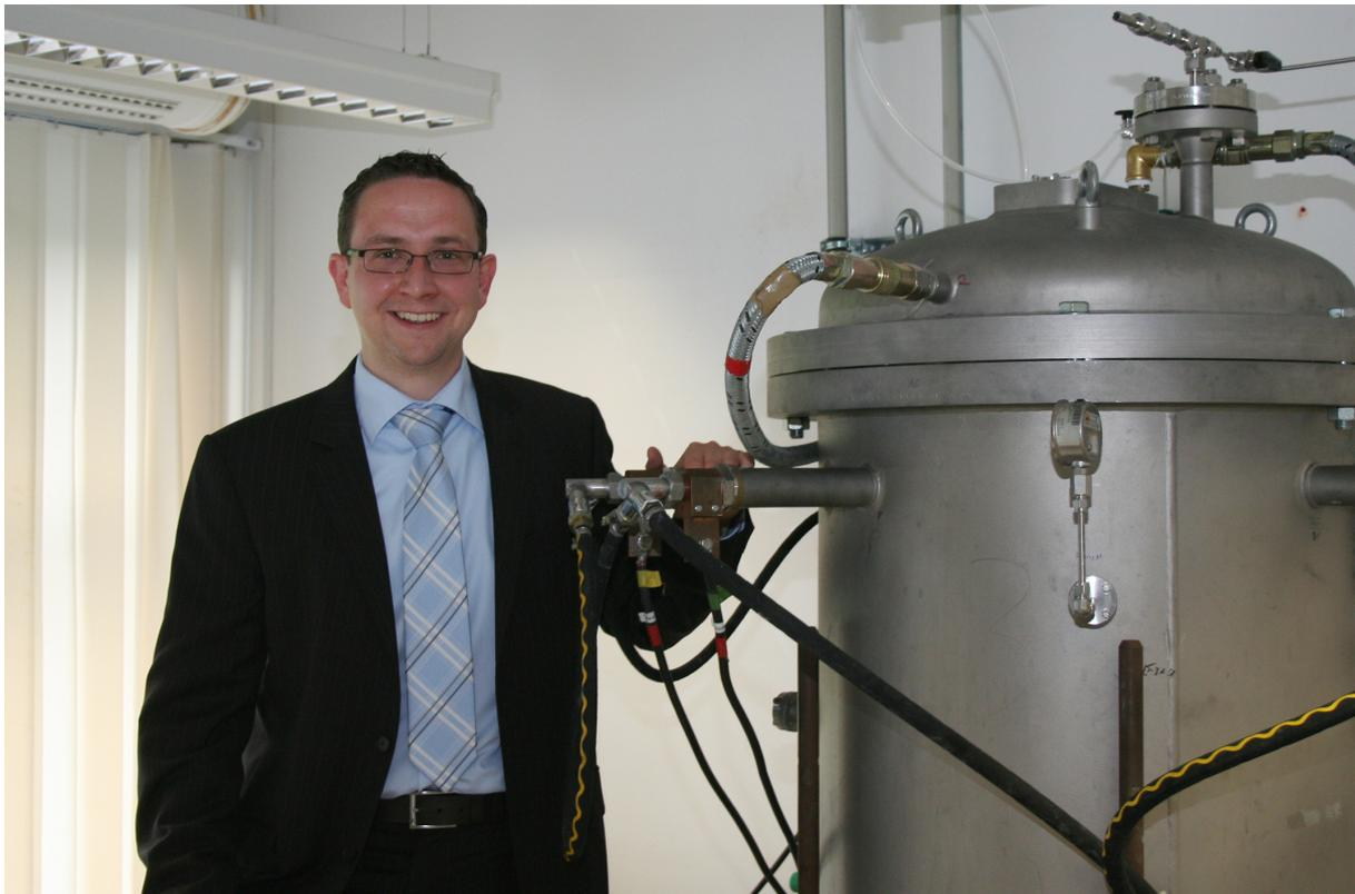
*Dr. Christian Reimann mit einer Versuchsanlage zur Kristallisation von Solarsilicium in seinem Labor am Fraunhofer IISB (Foto: Fraunhofer IISB).*
