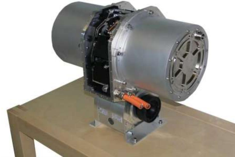
*Bild 1: Achsantriebseinheit – hier als Ausstellungsobjekt mit geöffneter Leistungselektronik (Foto: Fraunhofer IISB).*
