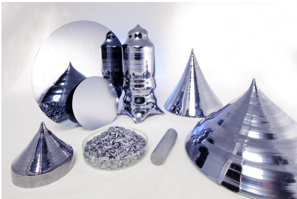
Anfangsstücke von Siliciumkristallen mit unterschiedlichen Kristalldurchmessern und daraus gefertigten Wafern sowie Ausgangsmaterial für die Siliciumkristallherstellung. Foto: Fraunhofer IISB / Kurt Fuchs
