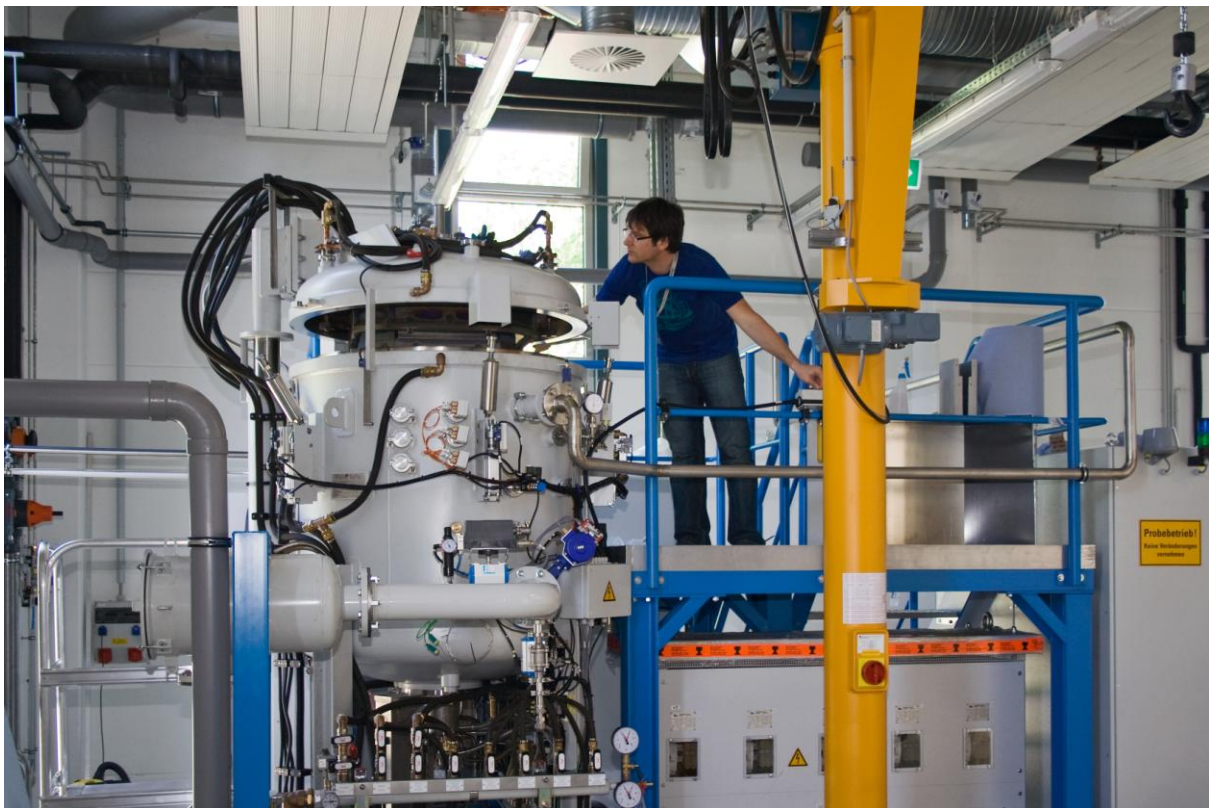
G1-Kristallisationsanlage zur Optimierung von Silizium-Halbleitermaterialien am neuen Technikum des Fraunhofer THM in Freiberg. Bild: Fraunhofer THM
