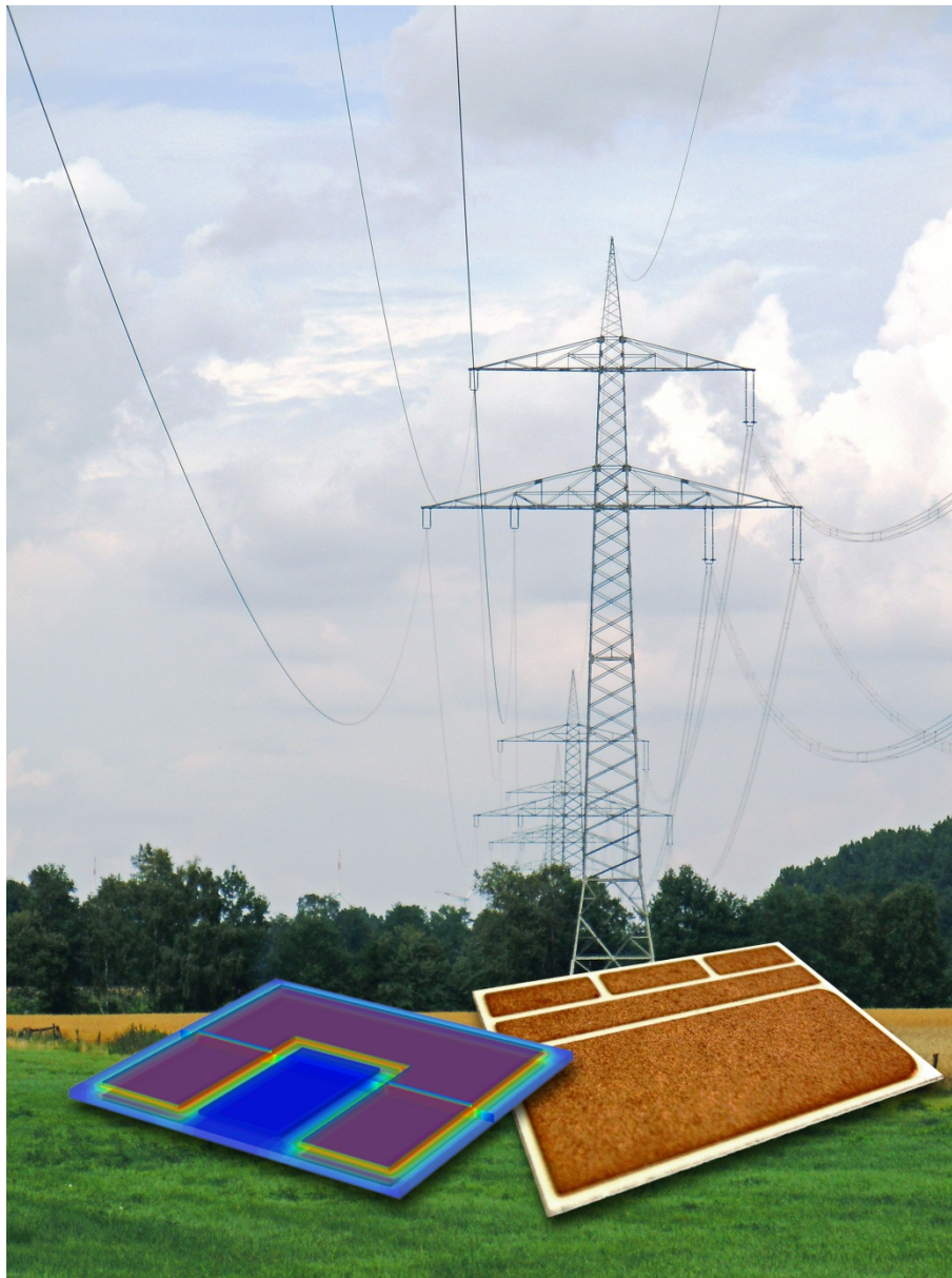
Im BMBF-Förderprojekt „APEX“ entwickeln curamik electronics und Fraunhofer IISB innovative DCB-Isoliersubstrate für hoch zuverlässige Leistungsmodul für Mittelspannungsanwendungen. Bild: Fraunhofer IISB
