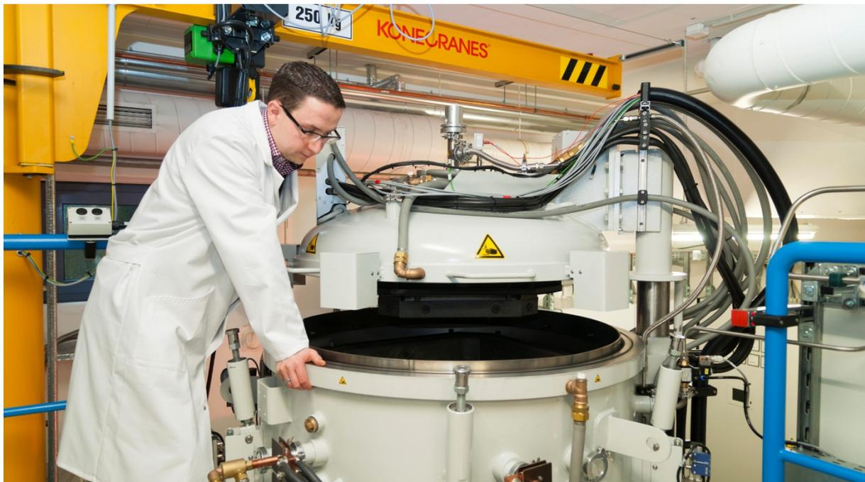
*Dr. Christian Reimann vom Fraunhofer IISB an der FuE-Bricon-G1-Kristallisationsanlage in Erlangen. Reimann erforscht im Projekt HENSi die kostengünstigere Herstellung von defektarmem und widerstandshomogenem n-Typ-Silizium für preiswerte Hochwirkungsgrad-Solarzellen durch gerichtete Erstarrung. Bild: Fraunhofer IISB*
