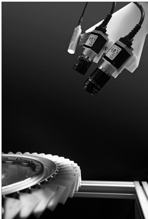
**Prototypische Inspektion der Oberfläche einer BLISK (Bladed Integrated Disk) mit zwei Kameras und einer Beleuchtung. (© Fraunhofer ITWM) | Bild in Farbe und Druckqualität: [www.fraunhofer.de/presse](http://www.fraunhofer.de/presse)**
