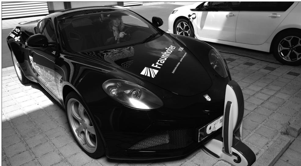
**Elektroautos berührungslos via Induktion aufzuladen ist noch Zukunftsmusik. Das Laden von der Vorderseite: Ein neuer Ansatz, der effizient und kostengünstig ist. (© Fraunhofer IISB) | Bild in Farbe und Druckqualität: [www.fraunhofer.de/presse](http://www.fraunhofer.de/presse)**
