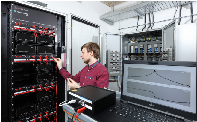
Bild 2: Stabilitätsmessung mit dem PRBS-Messsystem © Kurt Fuchs / Fraunhofer IISB
