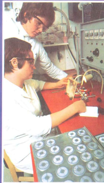
Die Ränder der Thyristor-Elemente werden noch einmal sorgfältig geätzt. Deutlich erkennt man die Aluminium-Kontakte auf den maskierten Flächen.
