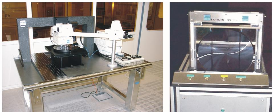
Fig. 1: Linke Seite: 300 mm-Mikroskop (Hellfeld, Dunkelfeld, Differential Interferenz Kontrast, 50fache bis 1000 fache Vergrößerung), Rechte Seite: 200/300 mm-System zur Bestimmung der Wafergeometriegrößen (Dicke, Total Thickness Variation, Bow, Warp);
