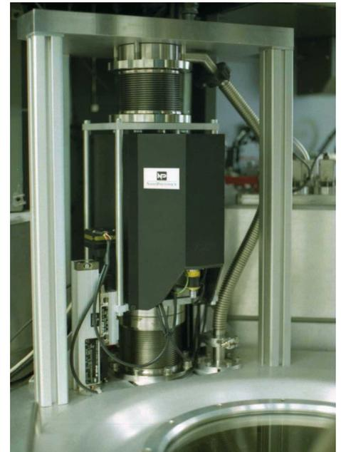
Fig. 2: In die Transportkammer integriertes kompaktes Ellipsometer zur Bestimmung von Schichtdicken direkt nach der Abscheidung; Compact ellipsometer integrated in the transport chamber for determination of layer thickness immediately after deposition.
