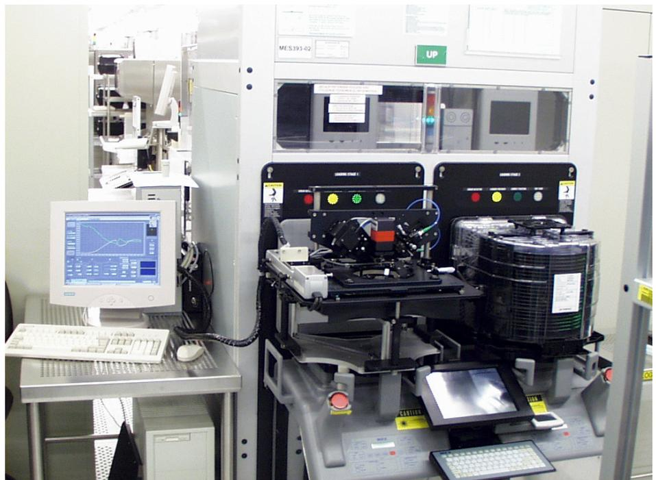
Fig. 3: Geöffnetes Linienbreiten-Meßsystem IPCOS300a, angedockt an Scheiben-Handhabungssystem (mit freundlicher Genehmigung von Infineon / SC300 GmbH); Open linewidth measurement tool IPCOS300a on wafer handling system (courtesy of Infineon / SC300 GmbH).
