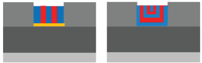
Schematische Darstellung der involvierten Materialien, oberer grauer Bereich: Führungsstruktur, rot/blauer Bereich: Blockcopolymer nach Selbstorganisation, gelber Bereich: mittels Spezialbehandlung präparierte chemisch neutrale Substratoberfläche
