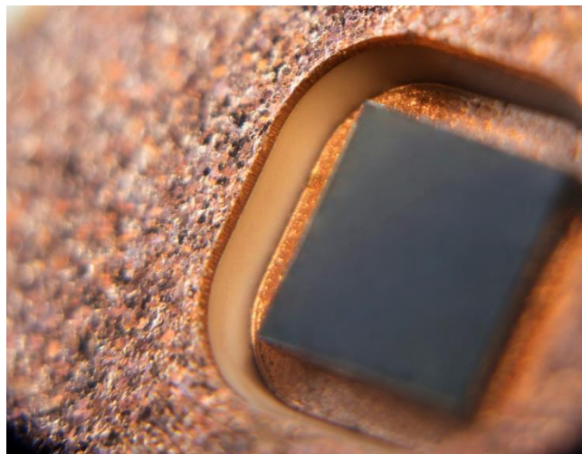
Nahaufnahme eines mittels der DCB-Embedding-Technologie eingebetteten Wide-Bandgap-Bauelements
