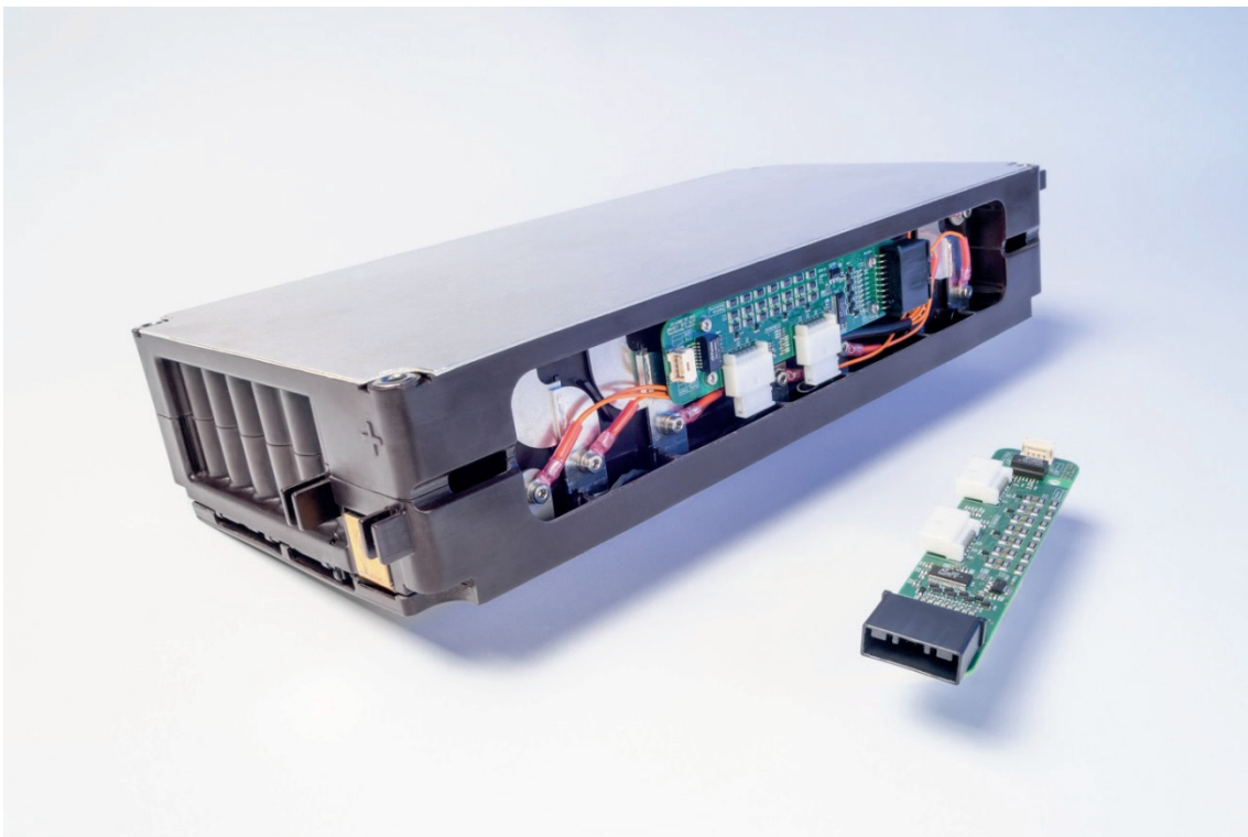
E-Fahrzeug-Batteriemodul mit hoher Energiedichte und kostenoptimierter Monitoring-Elektronik, entwickelt vom Fraunhofer IISB mit Dräxlmaier (Deutschland), Panasonic (Japan) und IFEVS (Italien).
