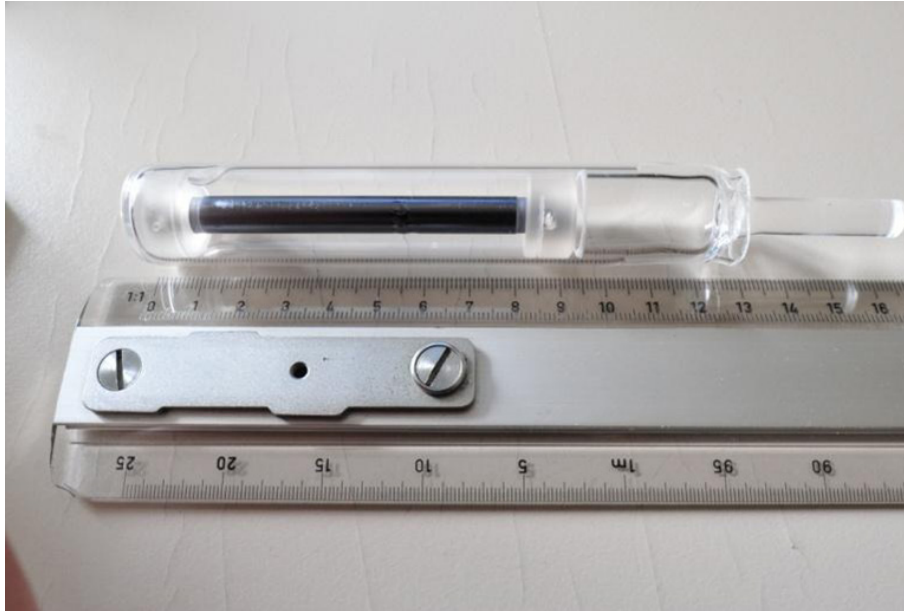
Terrestrische Vergleichsprobe des ParSiWal-II-Experimentes: Siliziumstab mit dem Partikeldepot (nicht sichtbar), der in einer Quarzglasampulle gehalten wird. Der Stab mit Ampulle wird in die Ofenanlage eingebaut, die als Nutzlast auf der Rakete mitfliegt.
